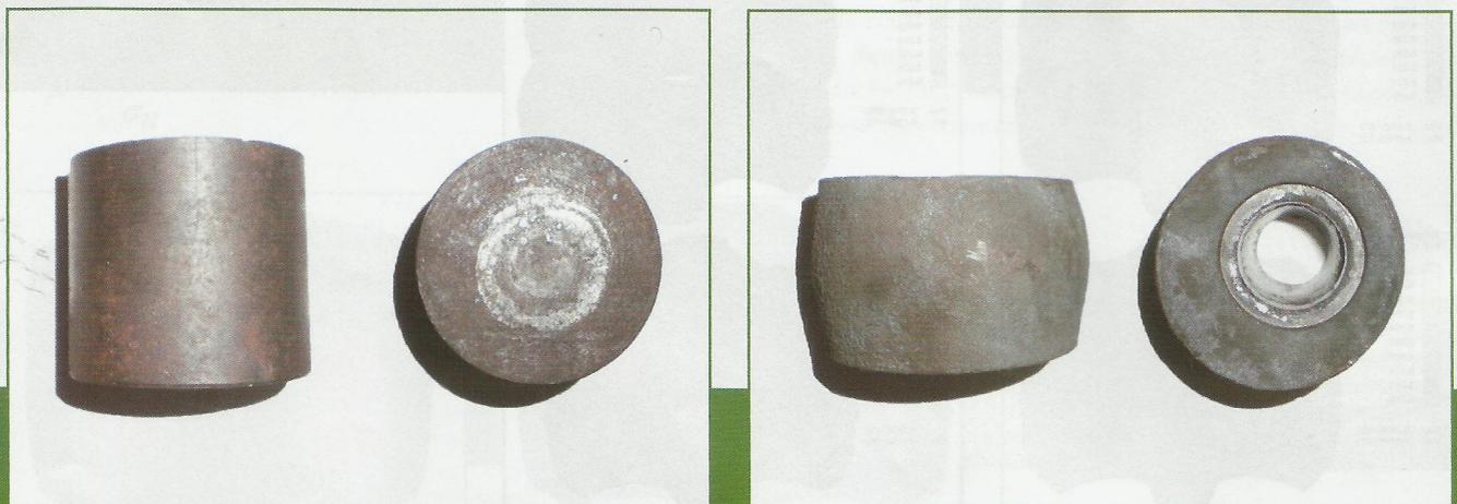
Figura 10. (a) Tarugo cilíndrico antes da furação. (b) Tarugo cilíndrico depois da furação
