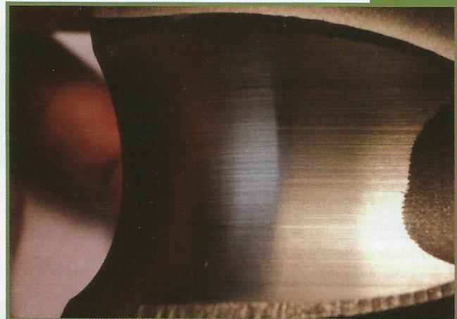
Figura 3. Defeito aparente na peça após passar pelo processo de retificação
